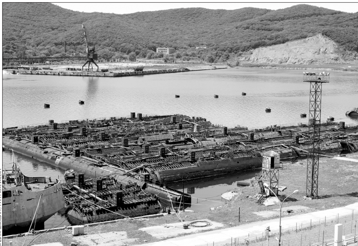
Трехотсечные блоки атомных подводных лодок ТОФ на плаву в бухте Разбойник: сейчас почти все они уже поставлены на долговременное хранение на берегу.
